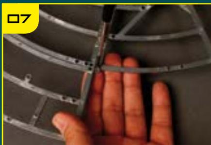
Закрутите еще один винт, чтобы зафиксировать раму BF-40 на ребре жесткости.
