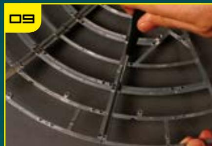
Зафиксируйте внутренний угол рамы BF-39, закрутив винт во фланец ребра жесткости.
