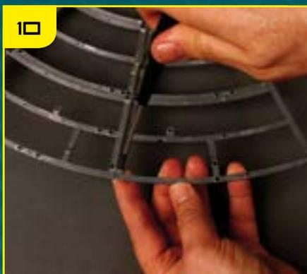
Закрутите еще один винт, чтобы зафиксировать угол рамы BF-39 на ребре жесткости.
